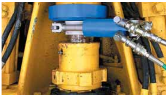
Гидравлический гайковерт серии JN в работе с верхней герметизирующей гайкой
