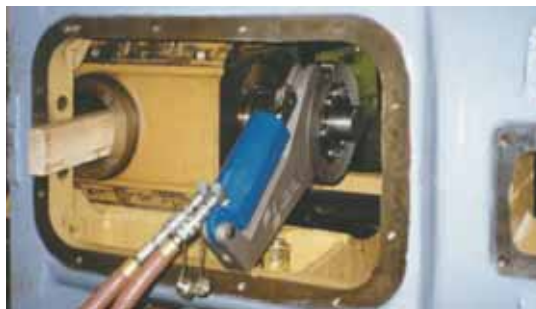
Гидравлический гайковерт серии JN в работе со стопорной гайкой
